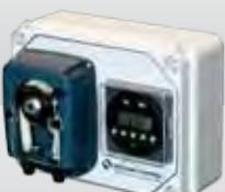
Pompa peristaltica con programmatore elettronico. Impostazioni di 8 programmi giornalieri o settimanali della durata minima di 1 minuto. Tubetto Santoprene®. Fornita di corredo pompe peristaltiche trattamento acqua. Disponibile anche versione con timer elettromeccanico, tempo di attivazione minimo 15 minuti.
